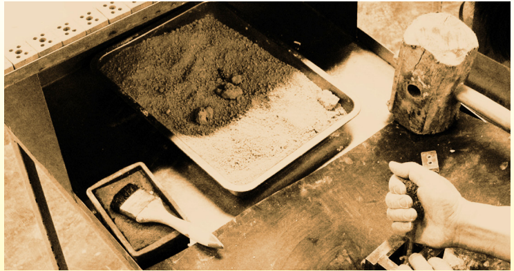
Borniers en porcelaine fabriqués manuellement par pressage au marteau : remplissage manuel du granulats humecté (Collection privée)
