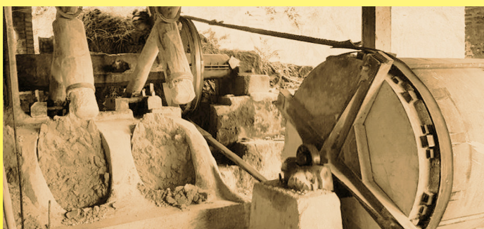
Machines de production traditionnelle des poudres (水碓 shui dui), utilisées pour fabriquer de la porcelaine électrique (collection privée)
